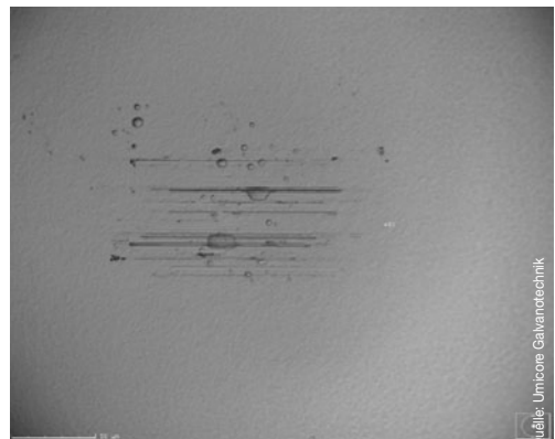
Silber-Reibspur mit Sealing 691 Reibkoeffizient: 0,04
